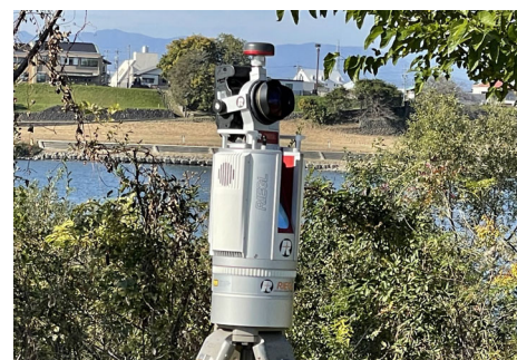
写真-2 地上レーザスキャナ：RIEGL VZ-2000i
